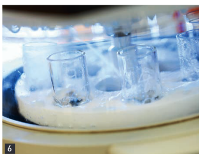
6 La rotación del carrusel permite bañar la muestra de forma óptima. La rotación es generada por el detergente a presión.
