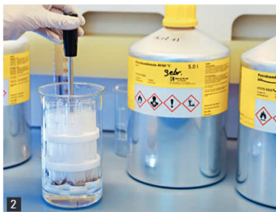
2 Desengrase cómodo y rápido con disolvente en el módulo de desengrasado. Se pueden desengrasar 6 muestras a la vez.
