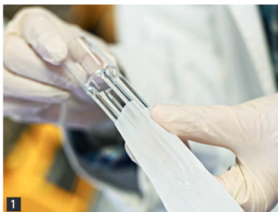
1 Fácil manipulación: insertar el separador de vidrio en la bolsa FibreBag, pesar la muestra y, listo. No es necesario cerrar la bolsa filtrante.
