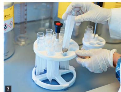
3 Al insertar las bolsas FibreBag en el carrusel de muestras quedan fijadas automáticamente y no pueden desplazarse.
