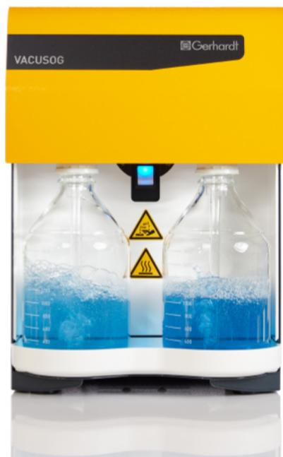
Potente sistema lavador de gases para separar y neutralizar los vapores ácidos inorgánicos resultantes de las digestiones Kjeldahl.
