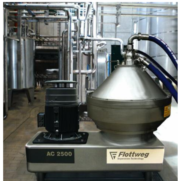
Centrifuga de Discos Flottweg, modelo AC 2500, para la clarificación de jugos de fruta y mosto
