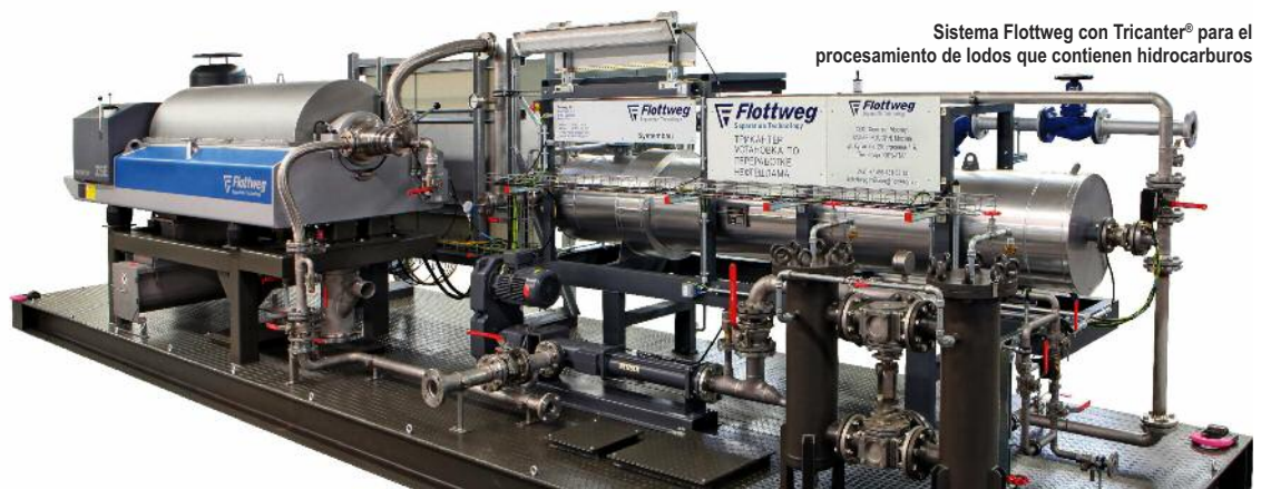
Tricanter® Flottweg (decanter de tres fases)
