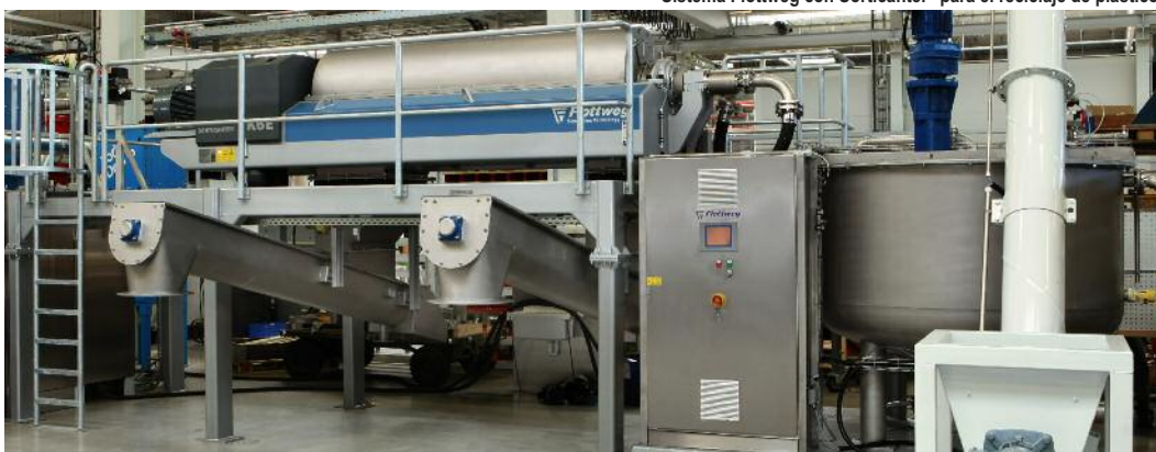
Sistema Flottweg con Sorticanter® para el reciclaje de plásticos
